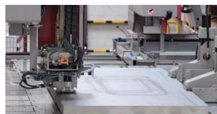
Behringer Type LPS 25-125-6A 90° drehbares Sägebänder; vollautomatischer Sägebetrieb für Serienfertigung vorweg: Moderner Maschinenpark
