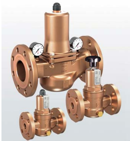
Druckminderer bis DN 100: Für höchste Ansprüche aus hochwertigem Rotguss und korrosionsbeständigem sowie säurefestem Edelstahl. Der Ventileinsatz ist aus Edelstahl gefertigt.
