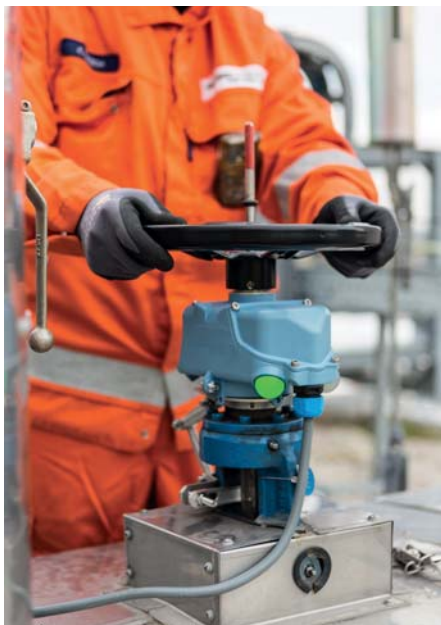
Zuverlässig liefert das VPI Endlagenmeldungen von handbetätigten Armaturen
