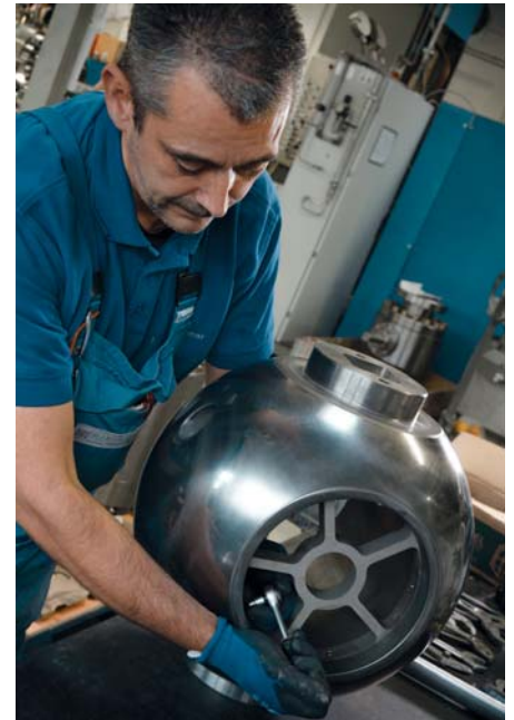
Die rein metallisch dichtenden Hartmann Kugelhähne erfüllen eine Leckrate von A beziehungsweise 0.
