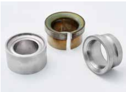
Auftragsschweißte Komponente vorgedreht, auftragsschweißst und fertiggearbeitet
