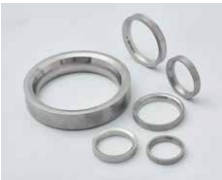
Gegossene Sitzringe aus Kobaltbasislegierungen in Größen nach Kundenanforderung, roh oder fertiggearbeitet
